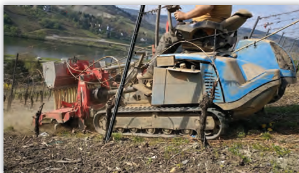
Ansaat der blütenreichen Zwischenzeilenbegrünung mit dem Raupenmechanisierungssystem. (Foto: BWV Rhld.-Nassau)
